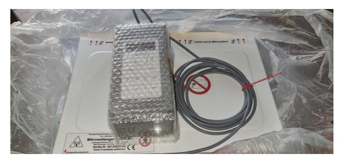
Wie auf dem oberen Bild zu sehen ist, zeigt die Rückwand nach unten. **Das ist wichtig**, da die Füße des Gerätes sonst nicht in den dafür vorgesehen Löchern stehen. Sie können nun das Gerät am Foliensack anheben und in die Kartonage absenken.
